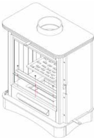
37. Kolejność demontażu oraz wymiany deflektora i wyłożenia acumotte – VEGA The procedure for the baffle and Acumotte lining disassembly and replacement – VEGA
